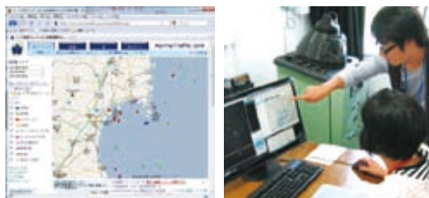
無線通信とコンピュータネットワークとの連携システム (船舶位置情報システムAIS)
