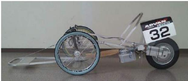
図3 組み立て後の3輪型教材用簡易電気自動車
