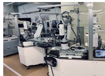
▲人・ロボット協調組立生産設備
