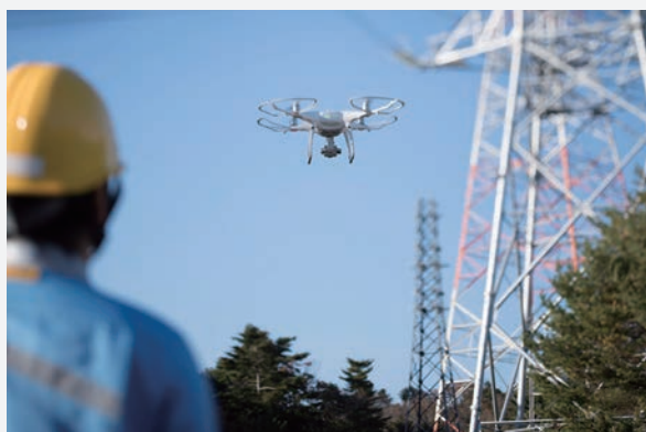
▲ドローン×AIによる鉄塔ボルトの異常診断
