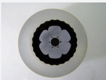
▲アルミ配電線断面図
