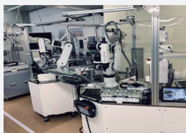
▲人-ロボット協調組立生産設備
