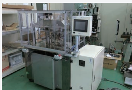
▲お客様からの要望で量産時に必要なプレス能力を測定するための切断・加圧試験装置を開発
