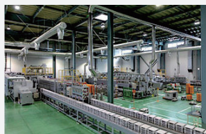
▲MIM工場内に設置されている連続式焼結炉
