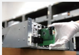
▲遠隔投入遮断受電部
