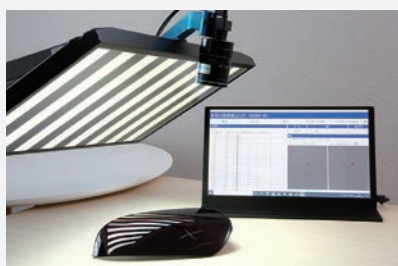
▲表面欠陥検査ユニット「SSMM-1R」
