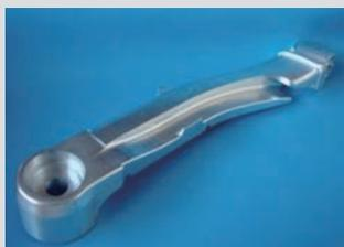
皆さんの良く知っている自動車のワイパーは様々な段階を経て商品化されます。その根元にあたる「アームヘッド」の最初の試作モデルを弊社で製作しています。3D・CADを駆使し、一つずつ機械で削り出し、最後には丁寧に手で磨きます。出来た試作品はいろいろなテストを重ね、最終的にはアルミダイカスト品として量産化されます。
