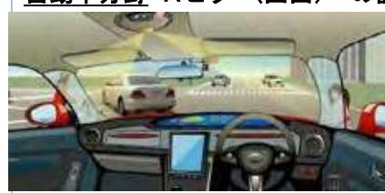
図5 Aピラー設置、疑似透明化
