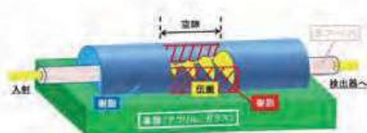
図2 溝を切った光ファイバによる光物性測定
