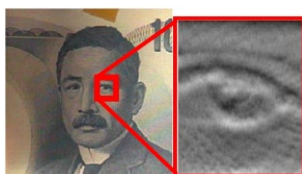
SQUID 顕微鏡による 紙幣の磁気像
