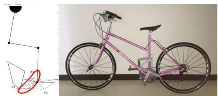
図2 一般用試作3号機のペダリング軌跡と外観
