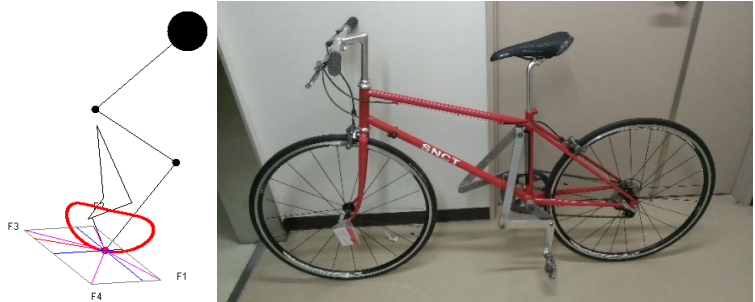
図1 スポーツ用試作3号機のペダリング軌跡と外観
