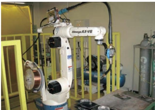
実験実習試作室 オフライン教示システムを備えた溶接ロボット
