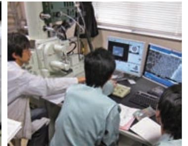
FE-SEMを用いた物質表面の観察実験
