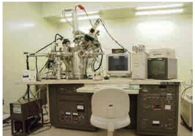
電子デバイス試作室 素材表面界面解析システム
