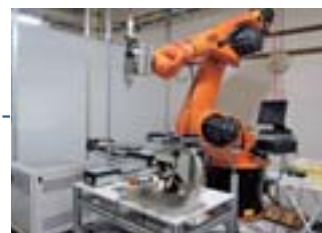
実験実習試作室 1.5kWファイバーレーザートーチ・ロボットシステム
