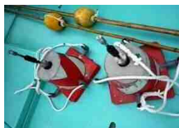
図1 設置治具に固定した流向流速計
