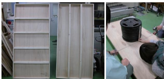
図5 天板の載荷実験
