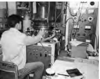
電子材料実験室のスパッタ装置
