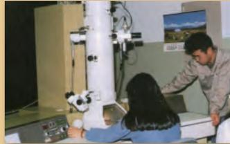
電子顕微鏡室の 200KV 透過型電子顕微鏡
