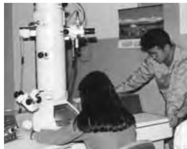
電子顕微鏡室の 200kv 透過型電子顕微鏡
