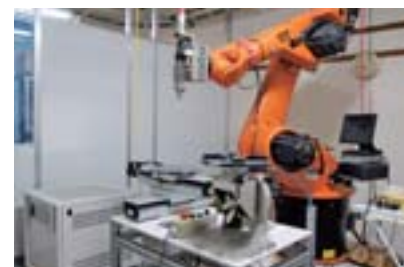
実験実習試作室 1.5kWファイバーレーザートーチ・ロボットシステム
