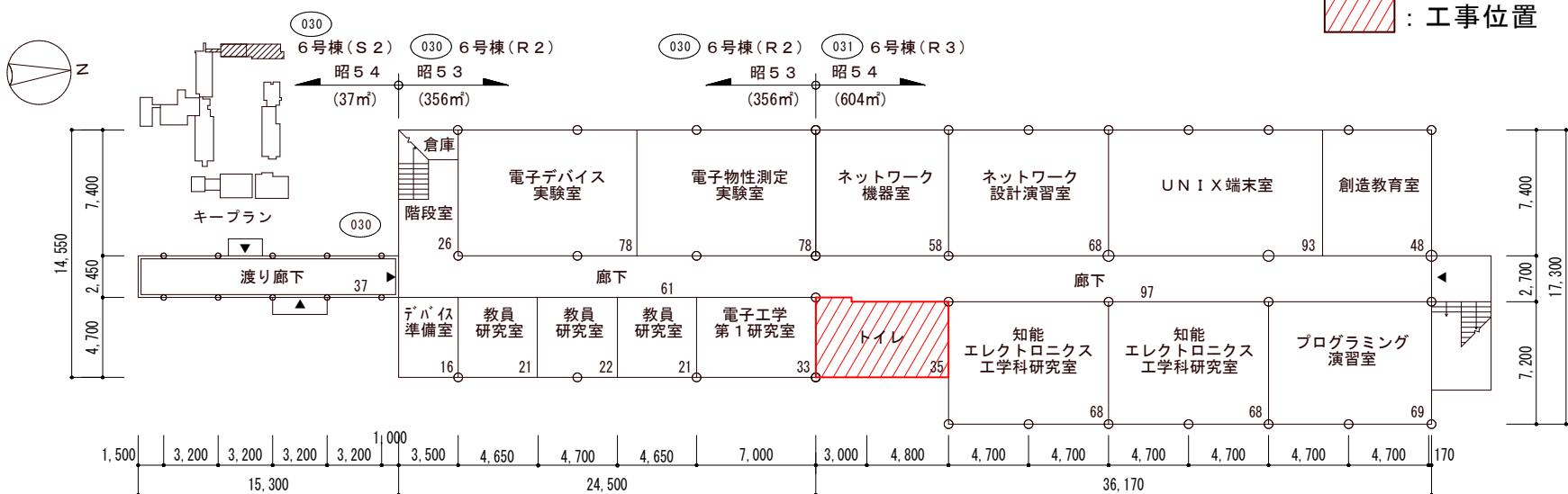
6号棟 1階改修後平面図 S=1/400
