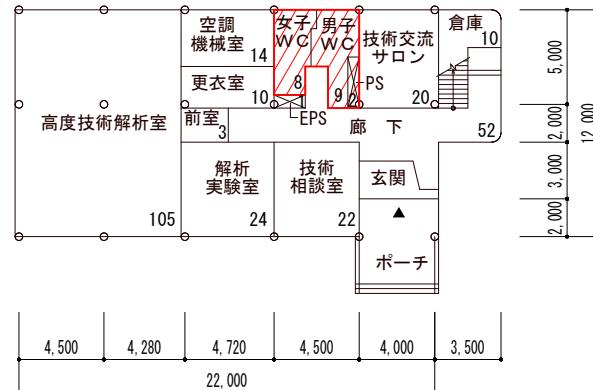
9号棟1階改修後平面図 S=1/400
