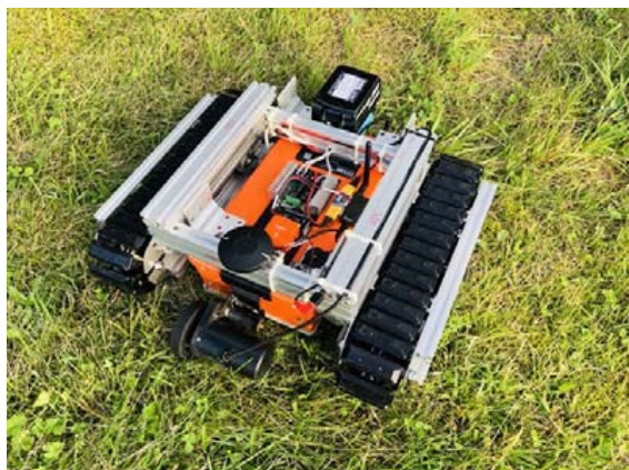
図1 AI搭載インフラ内部自動点検ロボット試作機の外観
