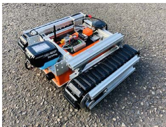
図1 AI搭載インフラ内部自動点検ロボット試作機の外観
