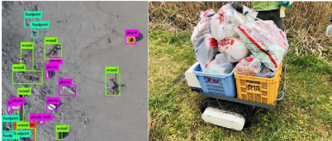
図2 開発中のAIによる海ごみ自動識別と自動回収運搬ロボット
