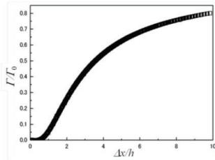
Fig.1 渦間隔と壁面に生じる循
