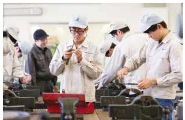
実習(手仕上げ作業)
