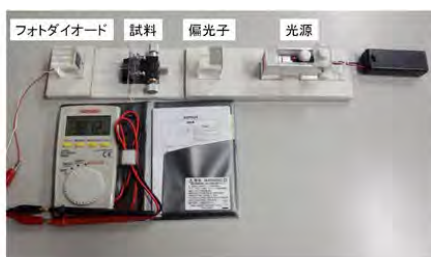
図1 試作されたブロック状光素子
