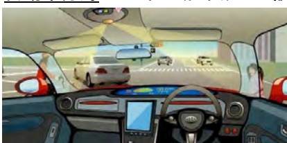
図5 Aピラー設置，疑似透明化 図6 開発した高輝度曲面スクリーン
