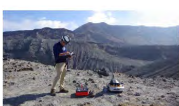
図 1 地中レーダ探査の実際とレーダ画像の例
