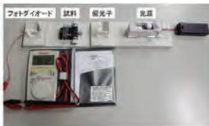
図1 試作されたブロック状光学素子
