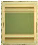
図 1. 広ダイナミックレンジ CMOS イメージセンサ
