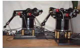
図 2. バイラテラルロボットシステム
