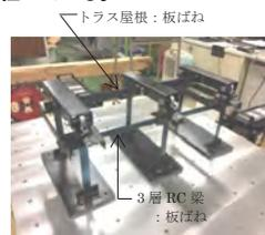
図3 縮小試験体による振動台加振試験
